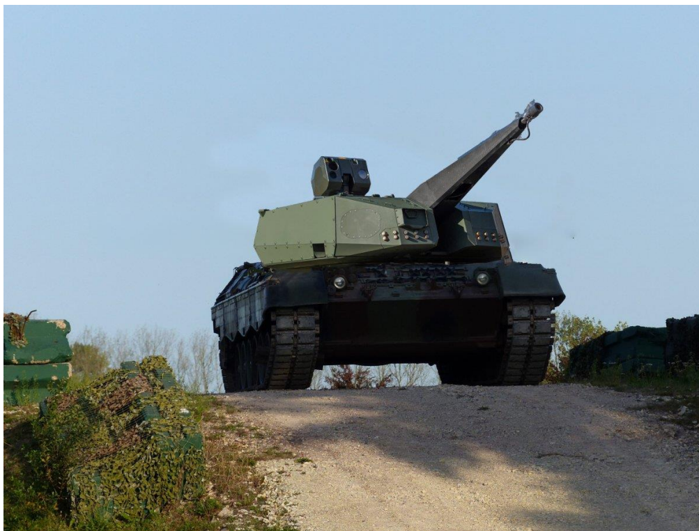
Самоходная зенитная установка Frankenstein, собранная Rheinmetall на основе зенитной башни Skyranger и платформы Leopard 1 для противодействия БПЛА. Фактически, часть проекта FrankenSAM, в рамках которого западные страны совмещают советские/российские технологии с западными, например, западные ракеты и советские ЗРК 308
