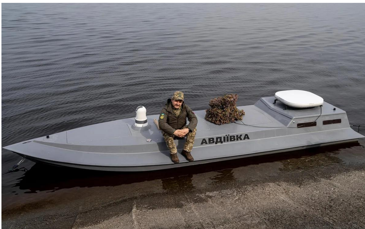
Sea Baby. Камуфляжной сеткой закрыт терминал Starlink, на «крыше» — терминал Kymeta 509
