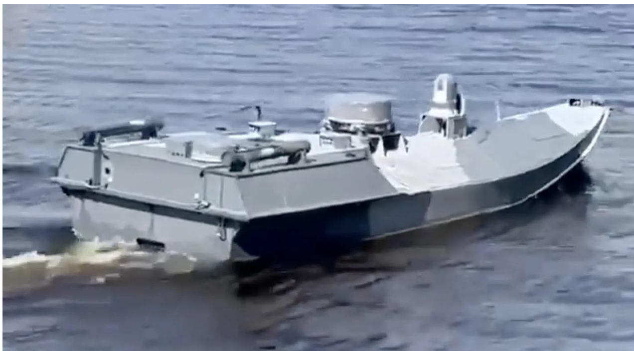
Sea Baby (вероятно, старая модель). Видны устройство связи (круглый элемент) и оптический прибор перед ним 508
